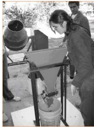
*Fig. 10 - Ensayos con el V-Funnel*
