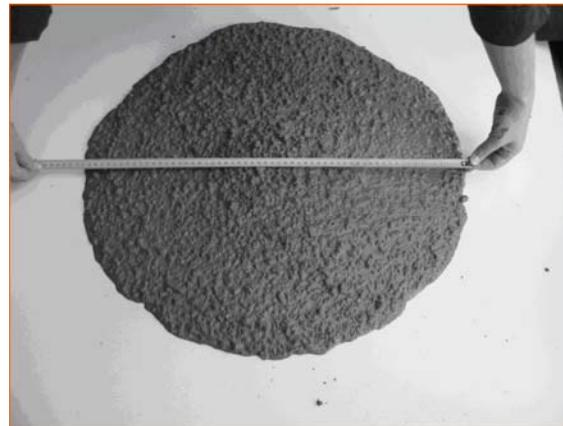
Fig. 4 - Aspecto del hormigón en ensayos de extensión
