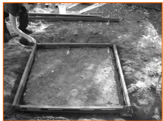
Fig. 6 - Parcela de medición instalada en campaña
