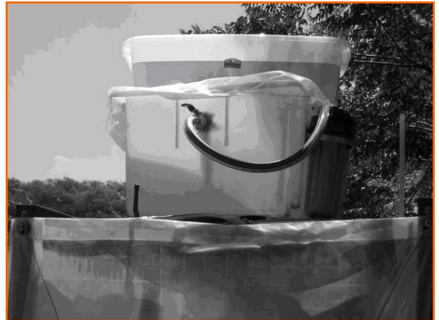
Fig. 8 - Tanques de alimentación y filtro de agua
