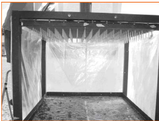
Fig. 5 - Puesta en régimen del simulador de lluvia
