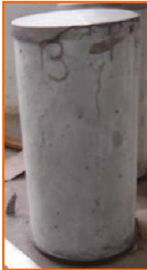
Fig. 3 - Probeta de hormigón simple. Modo de falla
