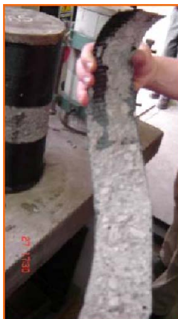
Fig. 6 - Rotura de la interfase material compuesto-hormigón
