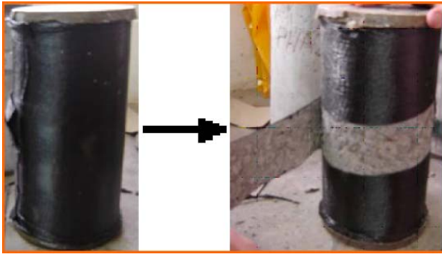
Fig. 4 - Probeta de hormigón simple confinada con PRFC. Modo de falla
