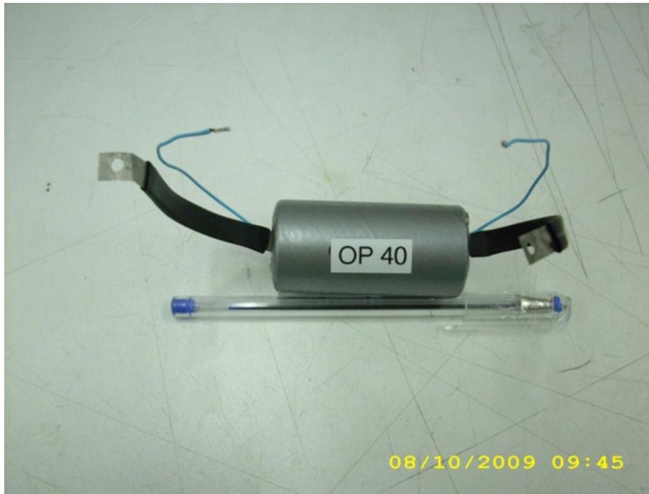
Fig. 5 - Celda comercial de ion-litio, 3.2V y 3.5Ah
