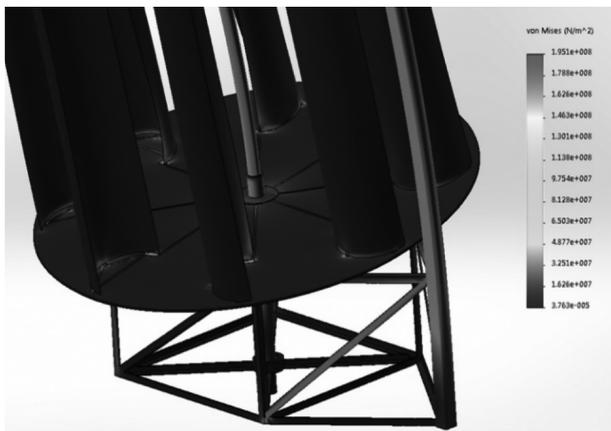
Fig.7: Resultado de tensiones obtenidos de la simulación (Factor: 10).
