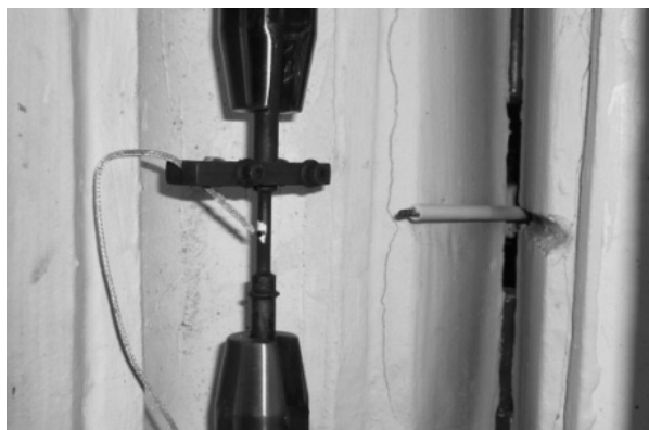
Figura 6 - Ubicación de las termocuplas del multímetro y del horno del equipo
