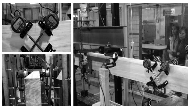
Fig. 4: Ensayo a flexión con determinación de módulo G.
