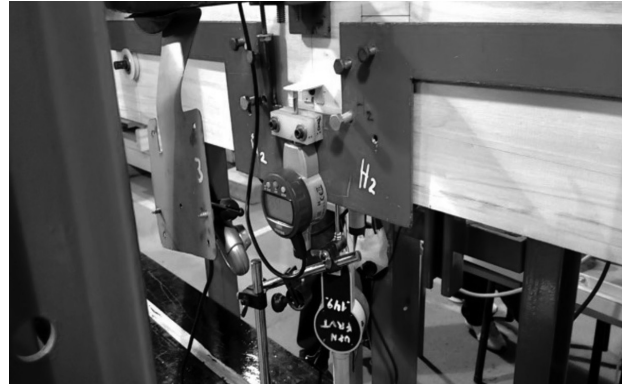
Fig. 2: Dispositivo de medición de las deformaciones.
