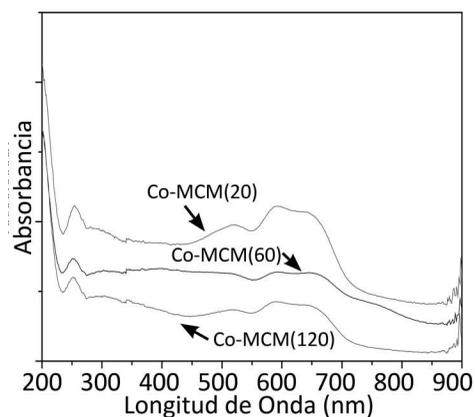
Figura 2b - Espectro UVvis-DRS para las muestras Co-MCM(x)
