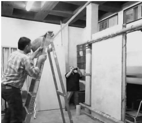
Fig. 9: Aplicación de cargas.
