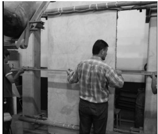
Fig. 10: Medición de deformaciones permanentes.
