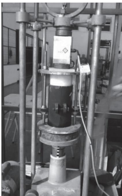
Fig. 2: Compresión en prensa.
