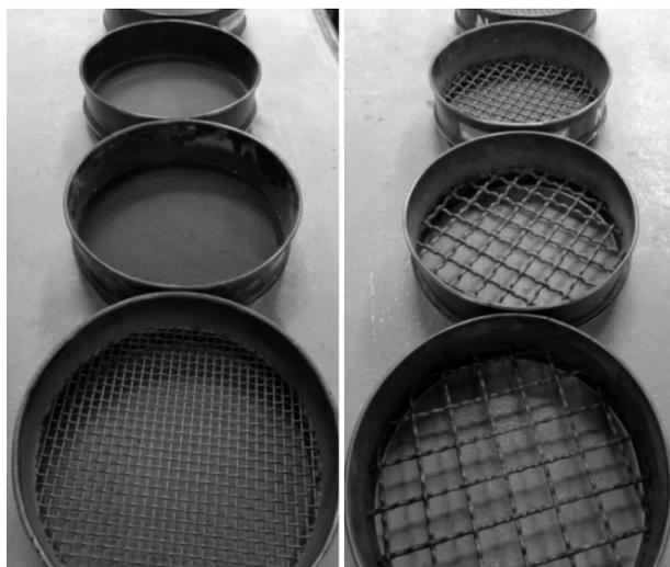
Fig. 4: A la izquierda se observa el juego de tamices utilizado para el agregado fino y a la derecha el utilizado para el agregado grueso.
