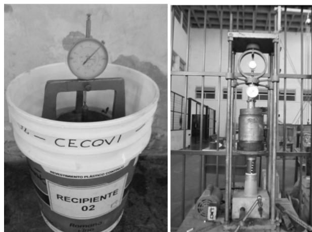
Fig. 8: Ensayo del VSR.
