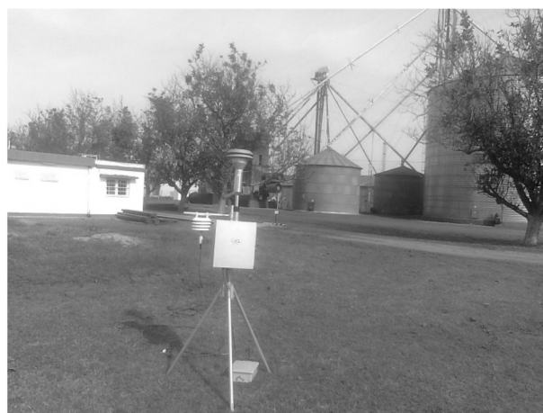
Figura 6 - Muestreo continuo de PM_{10} por Atenuación Beta
