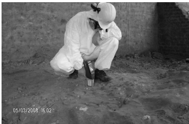
Figura 17 - Análisis de metales pesados in situ por XRF
