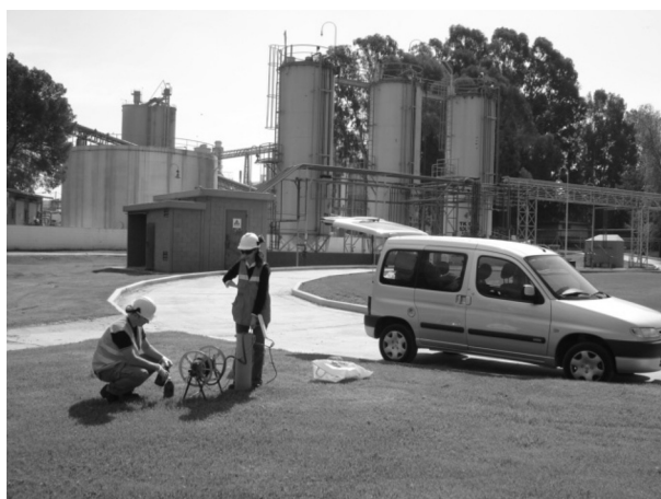
Figura 10 - Muestreo de agua subterránea
