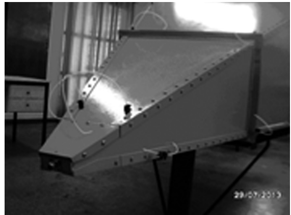
Figura 12 - Toma de excitación y recepción de RF
