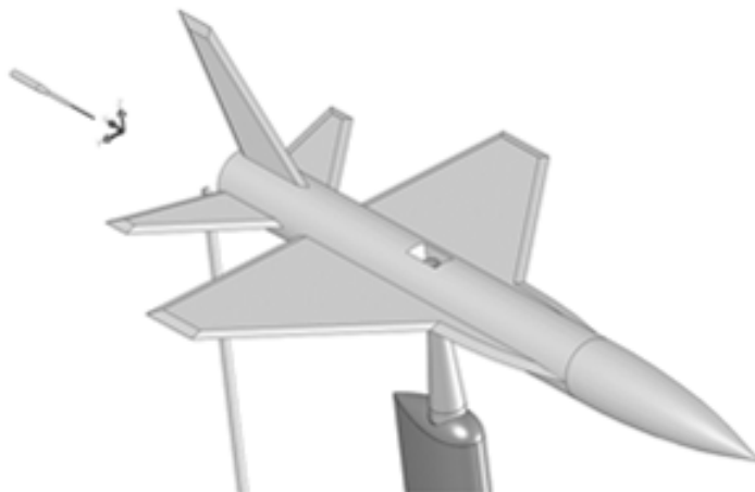
Figura 1: Mapeo de estelas de maquetas mediante sondas
