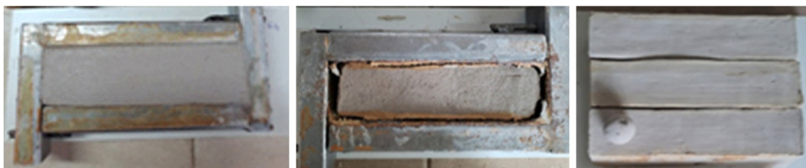
Fig. 1: a) Probeta de 4x4x16 cm recién moldeada. b) Probetas luego de la retracción. c) Probetas secas.
