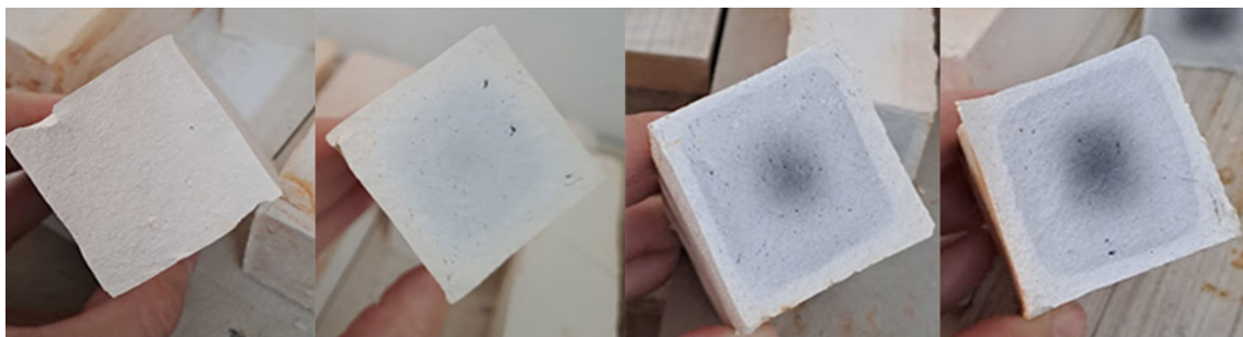
Fig. 12: Corte transversal de las muestras de arcilla en orden creciente de % de aserrín de MDF (F1; F2; F3; F4).
