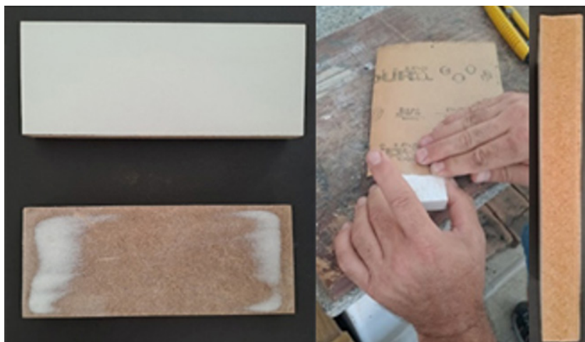
Fig. 9: Proceso de decapado de la cubierta de melamina para la cuantificación de los materiales del tablero.
