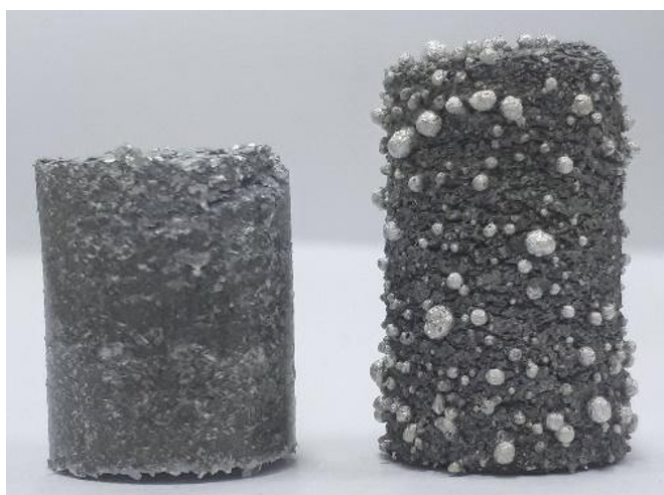
Figura 3. Muestra AlCu-5 antes del espumado y luego del mismo.
