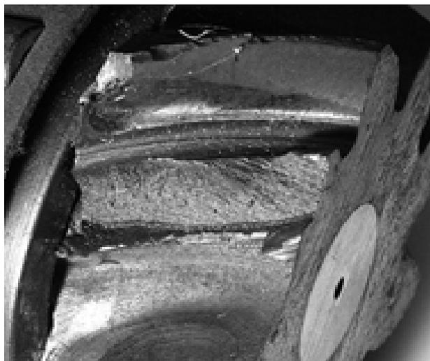
Figura 1. Falla de diente de engranaje por fatiga.
