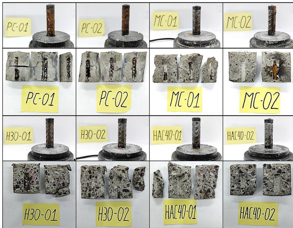
Figura 8 – Estado superficial de barras de acero y penetración de cloruros en mezclas cementicias puestos en evidencia en la inspección visual realizada al abrir las probetas.
