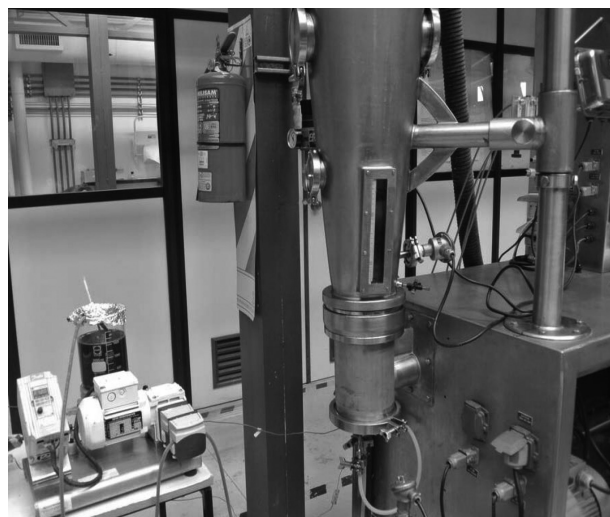
Figura 1. Sistema de inyección y precalentamiento del biol, y granulador.
