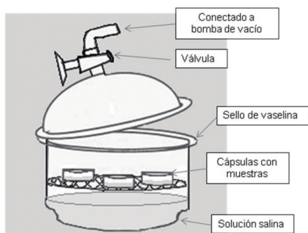
Figura 1: Desecador para control de humedades de equilibrio con soluciones saturadas.
