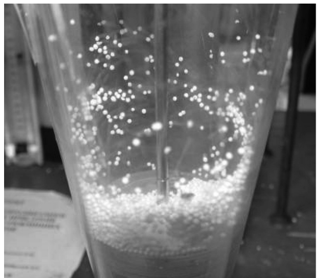
Figura 11. Clasificación de los gránulos por peso en el espacio de trabajo del granulador de vórtice.
