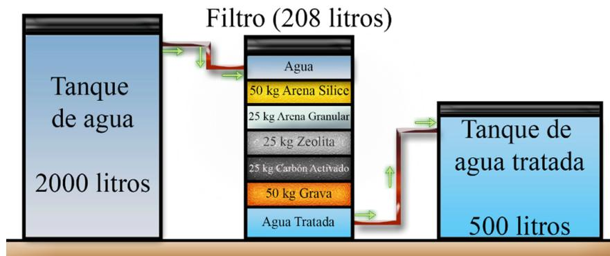
Fig. 7: Esquema representativo (no a escala) de un diseño alternativo para la implementación del filtro purificador de agua de uso doméstico (Avila Bareño y Moreno Figueroa, 2016). El diseño utiliza materiales similares a los empleados en el presente trabajo, pero de mayor costo.
