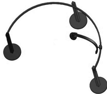
Figura 2 - Renderizado computacional del arco de soporte con el altavoz móvil.
