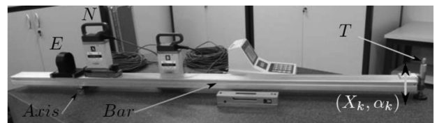
Figura 5. Experiencia de medición con el nivel electrónico y autocolimador.
