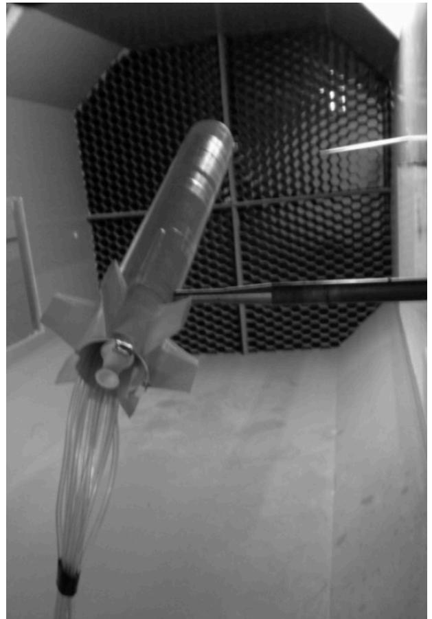
Figura 7 – ensayo de medición de presiones.
