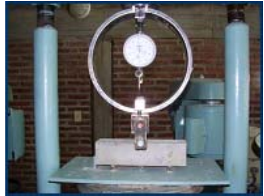
Fig. 3 – Ensayo a flexión de probeta de mortero
