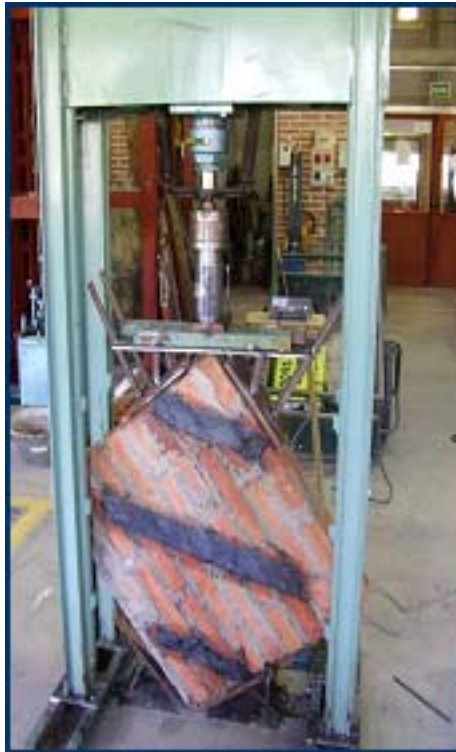
Fig. 5 – Ensayo de compresión diagonal de murete reforzado
