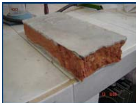
Fig. 1 – Mampuesto ensayado a compresión
