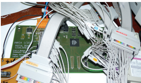
Fig. 1 Montaje experimental de la prueba del corazón del código del FPGA a 320
