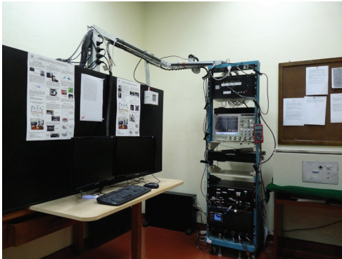
Fig. 1 Laboratorio de pruebas de PMTs, ITeDA. Se observa la caja negra y el sistema de toma de datos. específicamente para el sistema.
