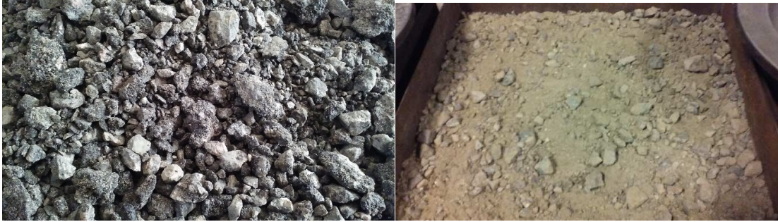
Figura 1: RMAP en la condición de secado en estufa a 60°C (Izquierda) RMAP luego del “lavado” (derecha)
