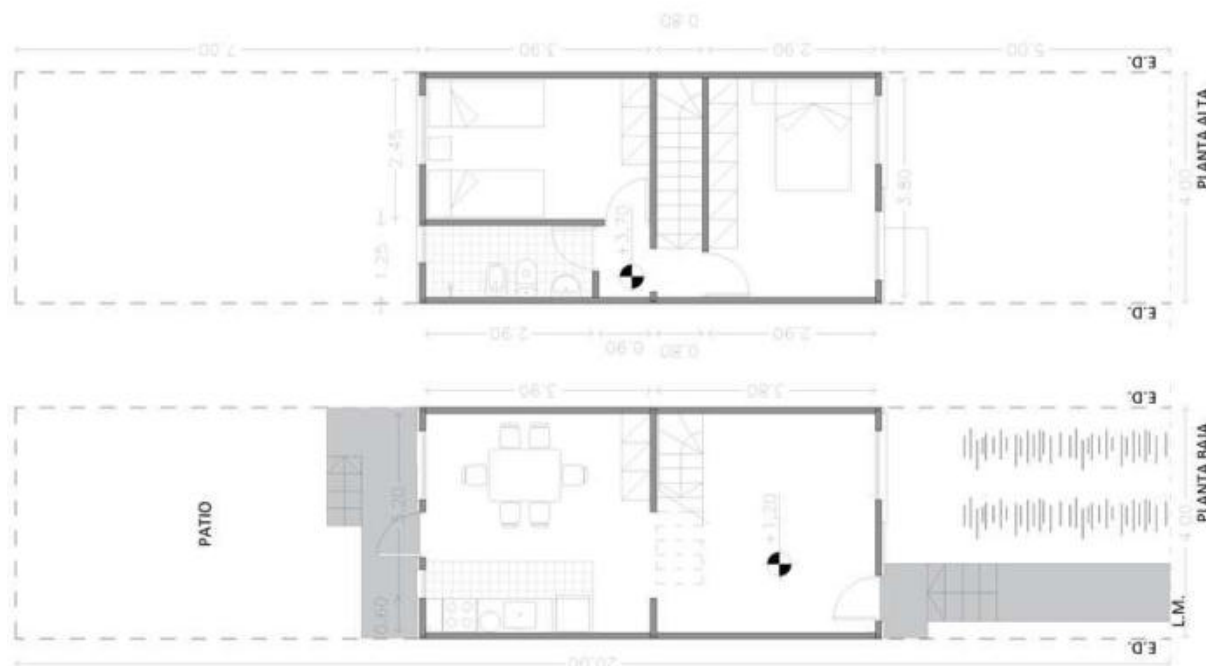
Figura 2. Plantas del dúplex de 64m 2 . Fuente: Propia.
