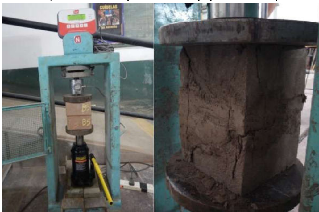
Figura 1. Ensayo de resistencia a compresión simple. Sobre una probeta de la serie “Cal 1”
