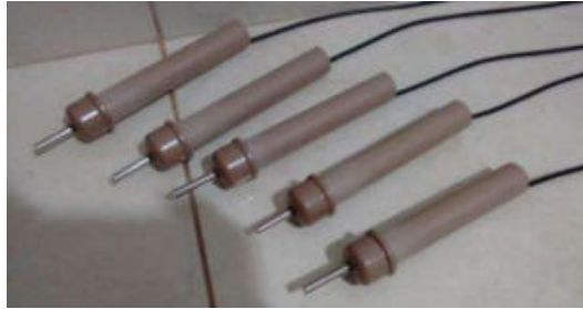
Figura 4. Preparação das ponteiras dos sensores.
