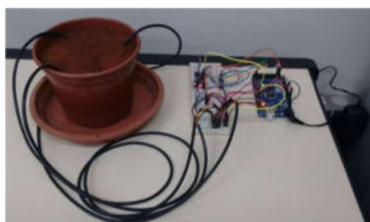
Figura 03. Layout de testes do sistema de detecção.
