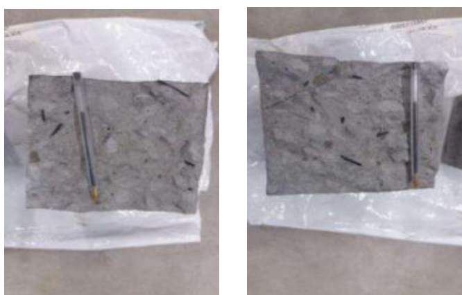
Figura 6 e 7 – Corpos de prova pós rompimento do compósito pelo ensaio de tração na flexão.
