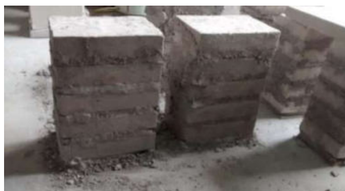
Figura 2. Pila de ladrillos producido con una prensa manual CINVA RAM.
