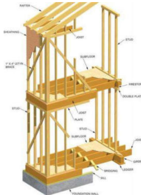
Figura 1. Sistema constructivo Platform-frame
