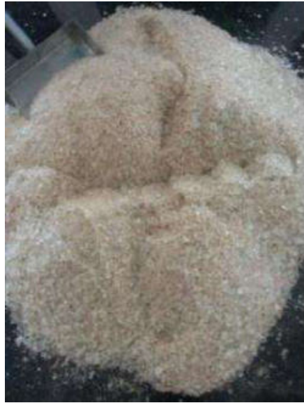
Figura 2. Vidro moído como agregado miúdo. Fonte: Sousa. (2016)
