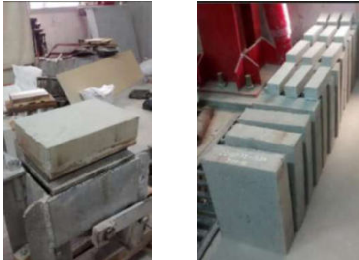
Figura 1. Ladrillos de Perlita producido con una prensa manual CINVA RAM.
