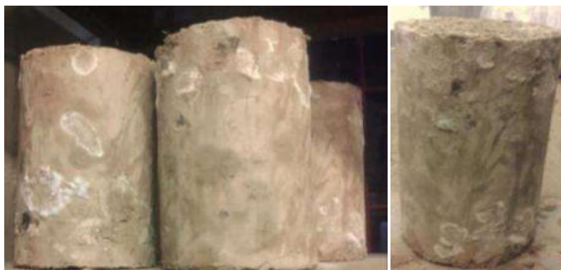
Figura 5. Probetas afectas con hongos.
