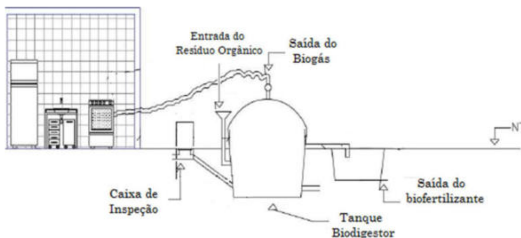
Figura 4. Projeto de instalação do biodigestor para tratamento de resíduo orgânico na POLI/UPE. Fonte: Adaptado de Souto (2017).
