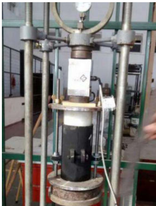
Figura 1. Moldeo por compresión en prensa
