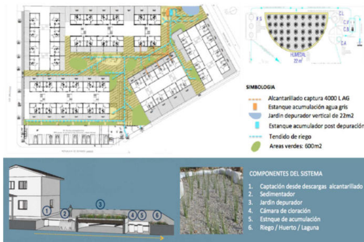
Figura 6. Sistema de reúso de agua gris tratada en jardín depurador o biofiltro
