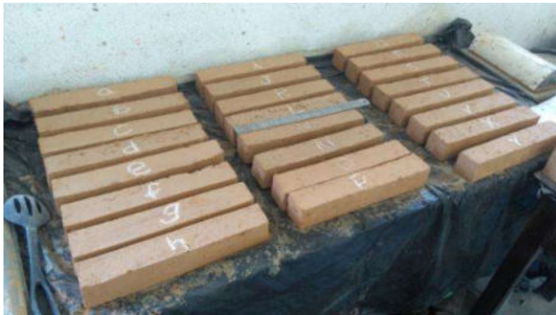
Figura 4. Prismas para ensaio de retração em processo de secagem.
