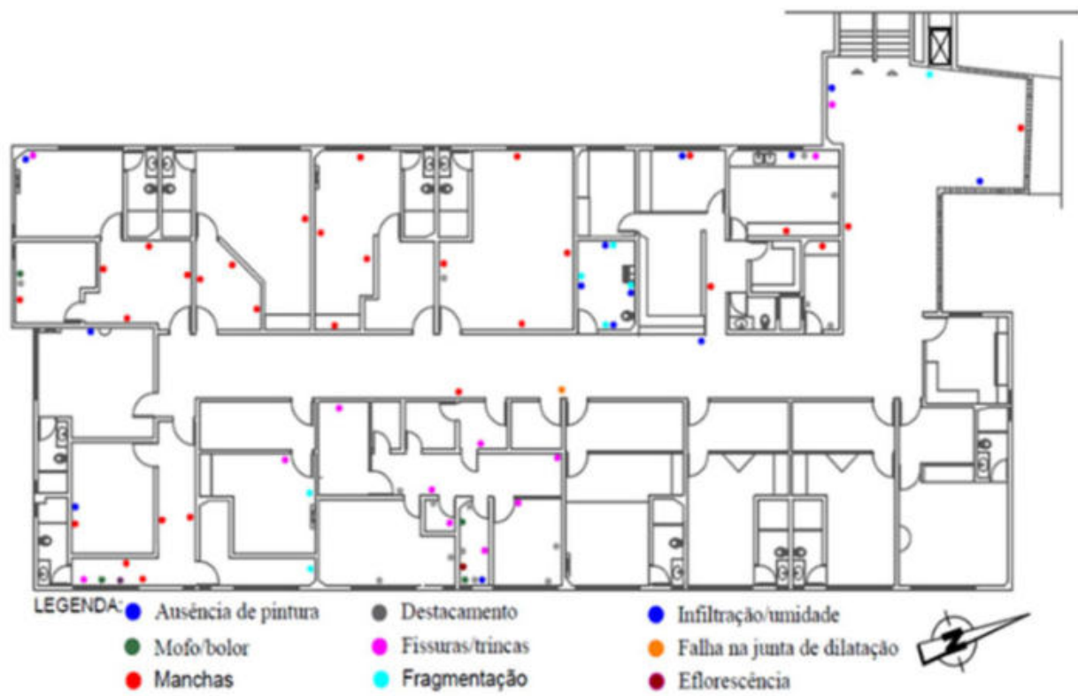
Figura 10. Mapa de danos relativo à parede.
