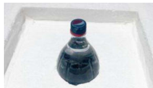
b. Garrafa PET de pé, com 2/3 da altura para o interior e o restante para o exterior.
