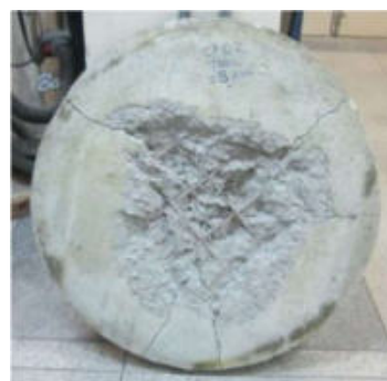
Figura 11 - Armadura Convencional (COOPETEC, 2014)
