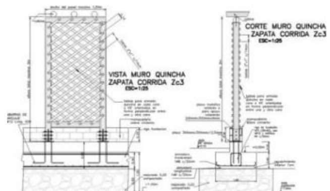
Figura 6. Modelado de quinchá cruzada y resolución de nudos para planteo como plano resistente a fuerzas laterales
