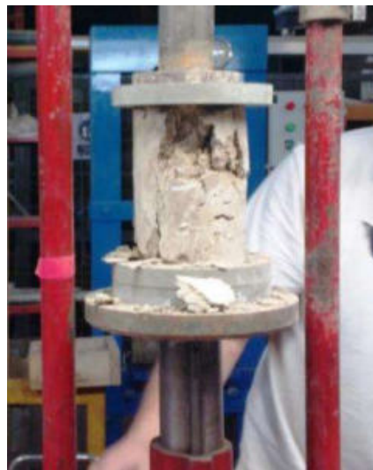
Figura 4. Ensayo a compresión simple.
