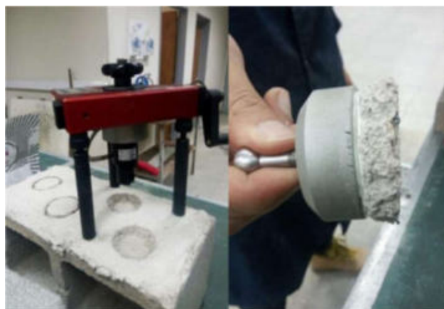
Figura 3. Ensayo de adherencia, muestra de ensayo y equipo de Pull Off
