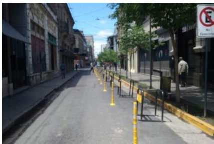
Figura 7: Estrechamiento de carriles con estacionamiento de bicicletas. Fuente: Grupo Cetram
