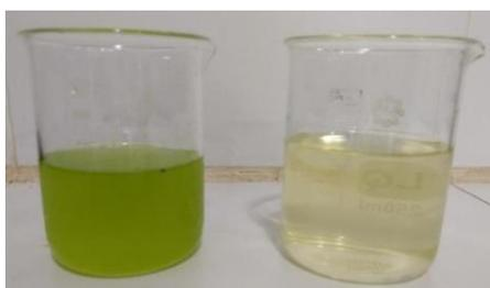
**Figura 3 – Efluente inicial (Izquierda) y Efluente final (Derecha)**
