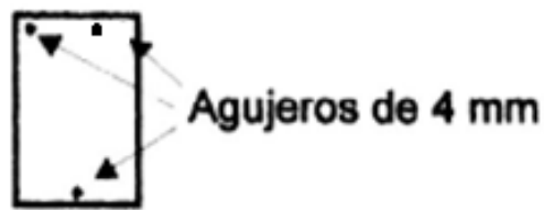
Figura 3. Cupón de corrosión perforado
