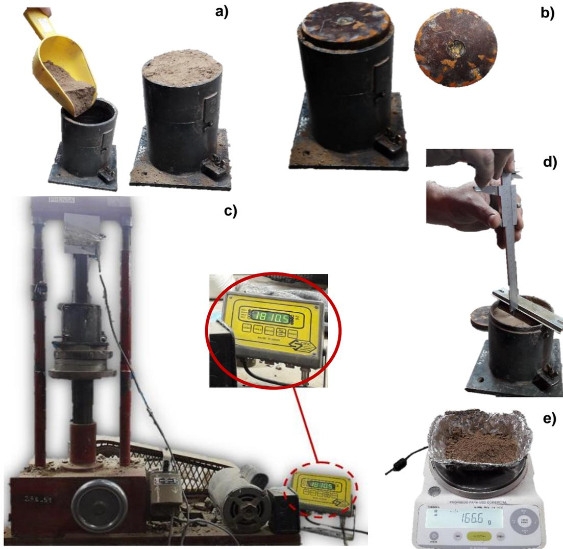
**Figura 5.** Procedimiento del ensayo proctor Standard adaptado.
