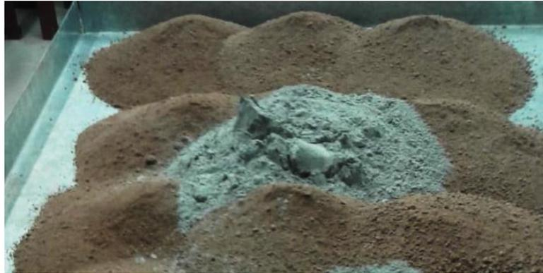
**Figura 1.** Dosificación volumétrica de la mezcla: 9 partes de tierra y 1 de cemento.
