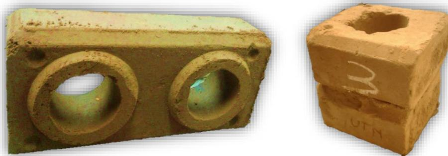
**Figura 6.** Probeta de BTC para ensayo a compresión.
