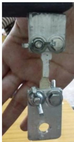
**Figura 3:** Mordazas para ensayo de tracción.
