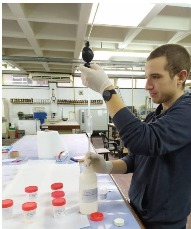
Figura 2: Llenado de recipientes con 75ml de una solución saturada de \text{Ca}(\text{OH})_2
