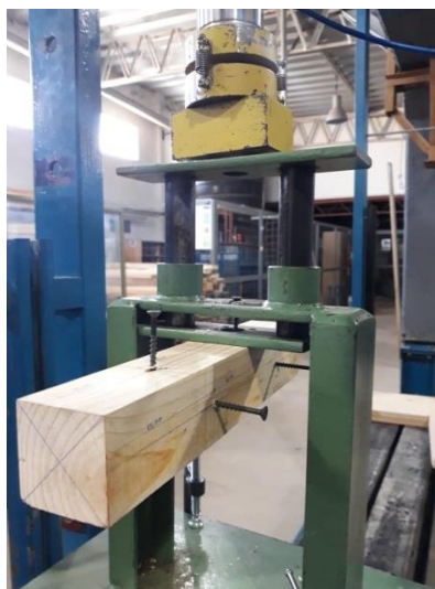
Figura 3. Dispositivo para ensayo.
