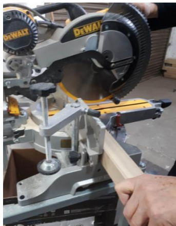
Figura 1. Corte de las probetas
