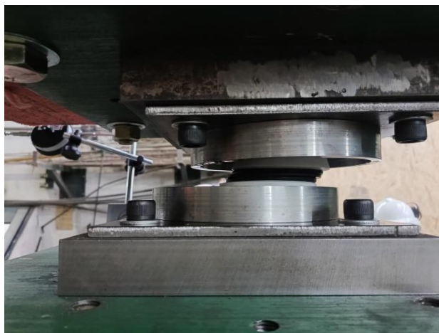
Figura 8. Ensayos a carga horizontal del dispositivo sísmico (CeReDeTeC, UTN-FRN, 2026)
