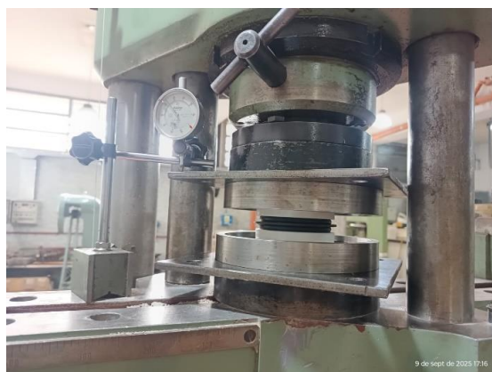
Figura 6. Deformación vertical y efecto barril del dispositivo sísmico (CeReDeTeC, UTN-FRN, 2025)
