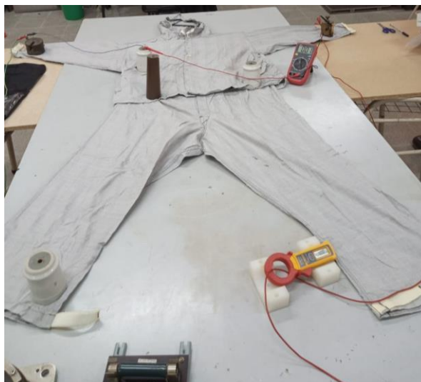
Imagen 6 – Disposición general desarrollo de ensayo de resistividad en la actualidad.
