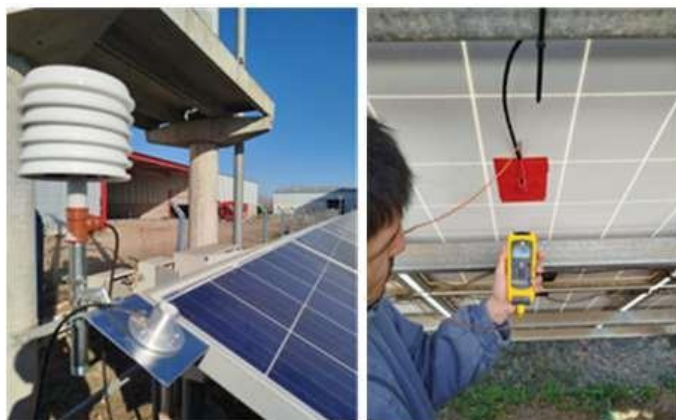
Figura 3: Montaje de piranómetro, cazoleta con sensor de temperatura ambiente y sensor de temperatura de paneles.
