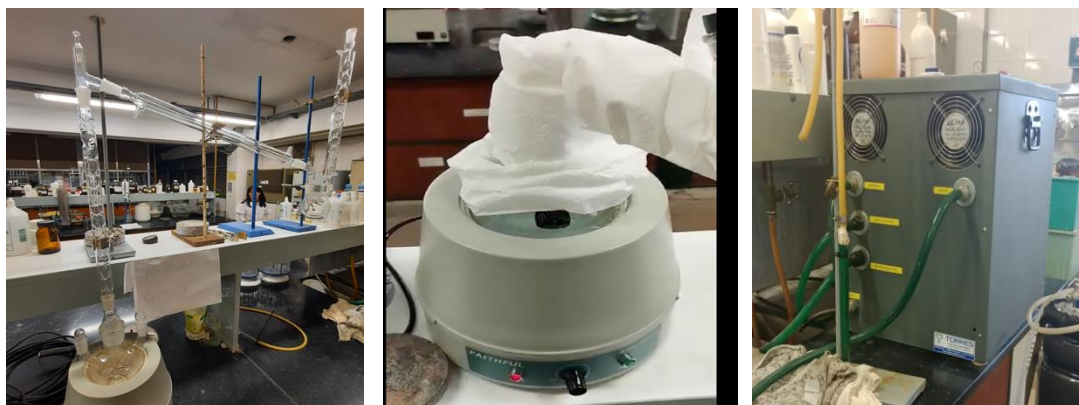
Figura 3: a) Equipo de destilación con sistema de calefacción y vacío. b) Manto calefactor c) Sistema refrigeración.
