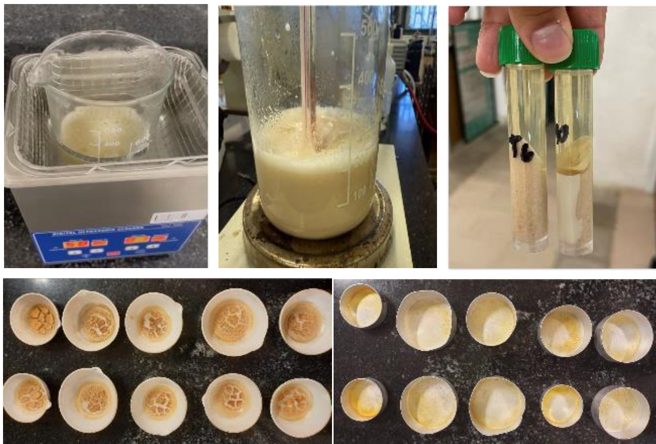
Figura 3: a) Etapa de sonicación b) Extracción c) Centrifugado d) Sólidos post secado e) Sobrenadante post secado.
