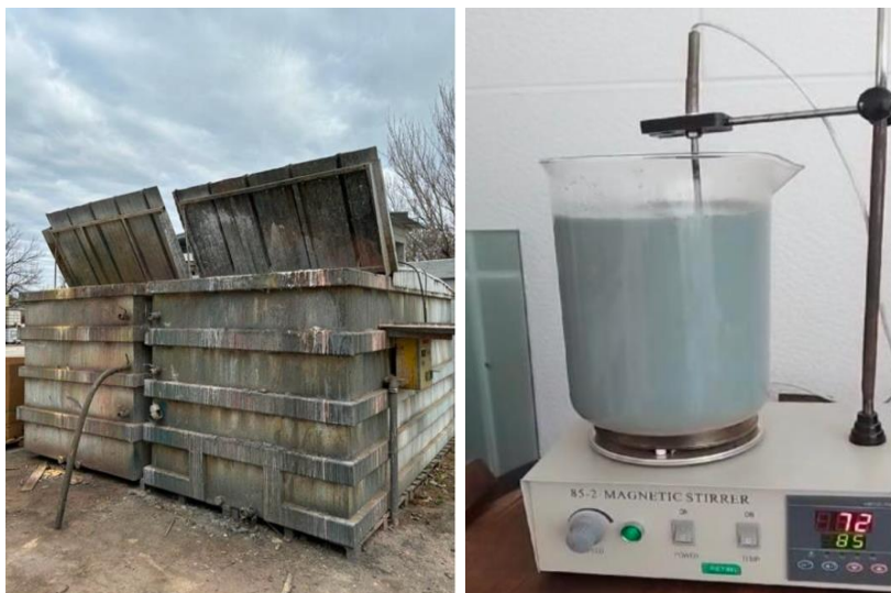
Figura 1: a) Tanques colectores de aguas de lavado; b) Aspecto típico del residual a procesar
