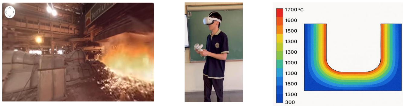
(a) Imagen extraída del video 360° del Alto Horno observado por (RV) (b) Estudiante utilizando un visor Meta Quest 2. (c) Modelización del crisol del Alto Horno-perfil térmico.
