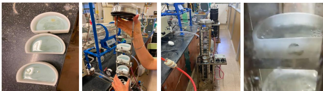
Figura 2: a) Cápsulas con carga inicial b) Sistema de carga vertical. c) Equipo de secado con sistema de calefacción y vacío. d) Concentración del residuo en las bandejas durante la operación.
