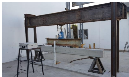
Figura 1. Viga de hormigón armado preparada para el ensayo de carga.
