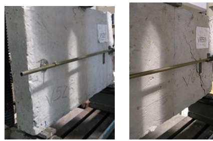
Figura 3. Modos de falla: a) vigas de hormigón sin fibras; b) vigas de HRFA.
