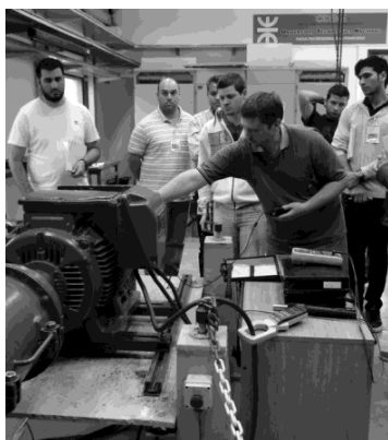
Fig. 5. Ensayo de un motor eléctrico
