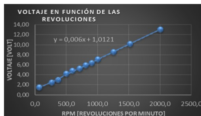
FIGURA 4. Resultados de la experiencia, Voltaje en función de las revoluciones por minuto.
