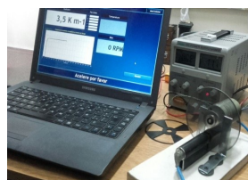
FIGURA 5. Instrumental y equipo empleado en la experiencia: chopper, notebook, regulador de voltaje y amperaje.
