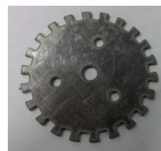
Figura 5: Disco para el encoder óptico.
