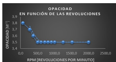
FIGURA 6. Opacidad en función de las rpm.
