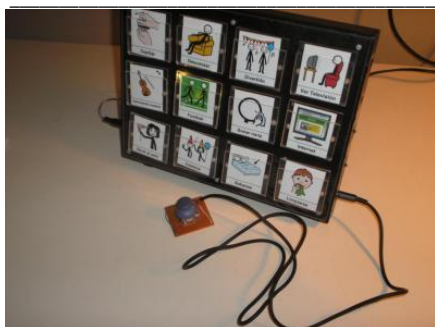
Fig. 4- Switch a varilla conectado a comunicador pictográfico manual
