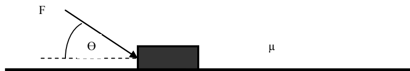
Figura 1: Esquema de un cuerpo de masa m al que se le aplica una fuerza F que forma un ángulo \theta con la horizontal sobre una superficie cuyo coeficiente de rozamiento es \mu
