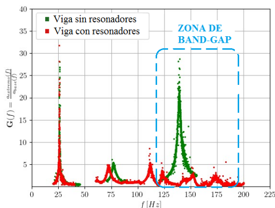
Figura 2: Fenómeno de band-gap o reducción de amplitud de oscilaciones.
