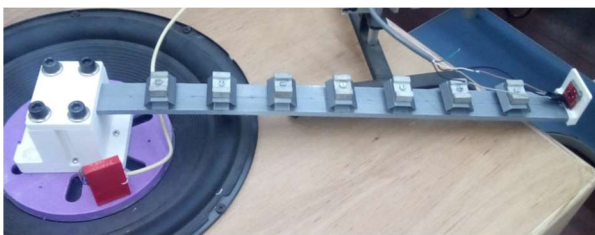
Fig. 1. Montaje experimental de la viga con resonadores masa-resorte
