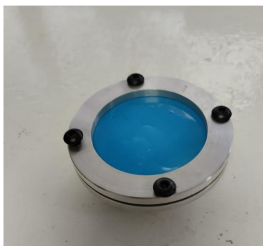
Figura 1. Film de PLA en celda de WVT.
