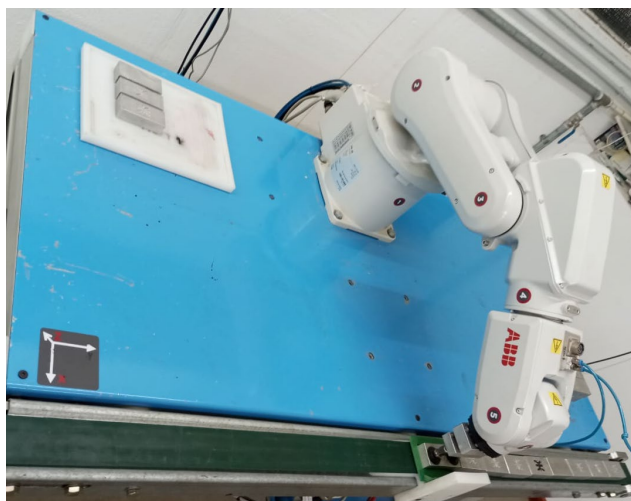
Figura 2. Mesa donde se realiza la simulación de paletizado.
