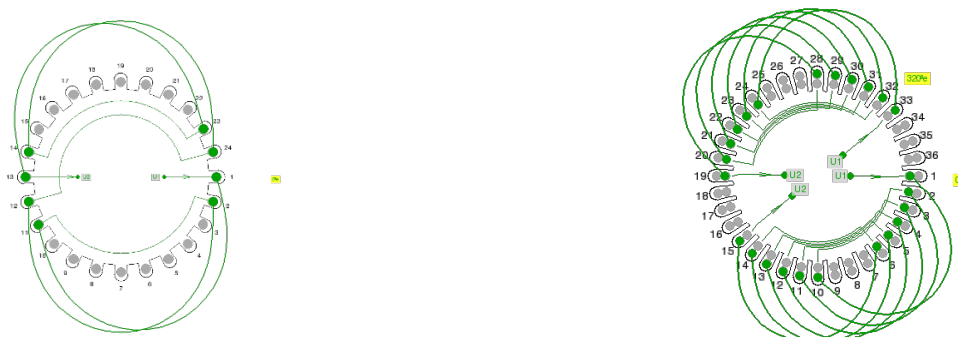
Figura 3. Una fase de bobinado: a) motor de 1,50 kW, 2 polos, con. estrella, 24 ranuras, 2 polos, 1 vía, 1-11, ka = 0,958; b) motor de 1,60 kW, 2 polos, con. doble estrella, 36 ranuras, 2 polos, 1 vía, 1-10, ka = 0,676.
