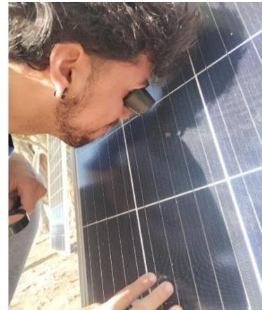
Figura 3. Inspección visual con lupa [Elaboración propia]
