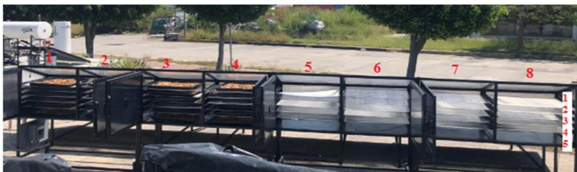
Figura 5 Secador solar tipo túnel en un prueba de secado con irradiación de 12.3 MJ/m<sup>2</sup>, humedad relativa ambiental de 48.6 % y una temperatura ambiente de 34.2 °C.
