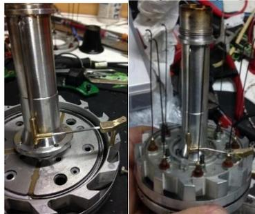
Figura 5 Nueva cañería de lubricación y montaje. [Elaboración propia]
