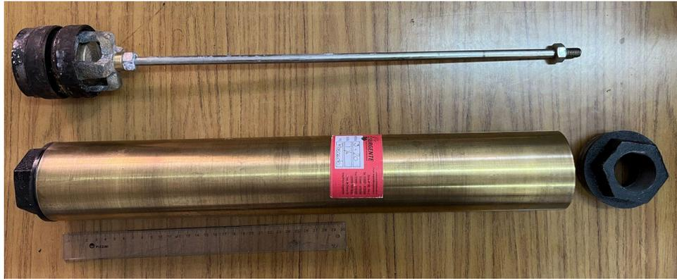
Figura 9 - Despiece del cilindro de bombeo. [Elaboración propia]
