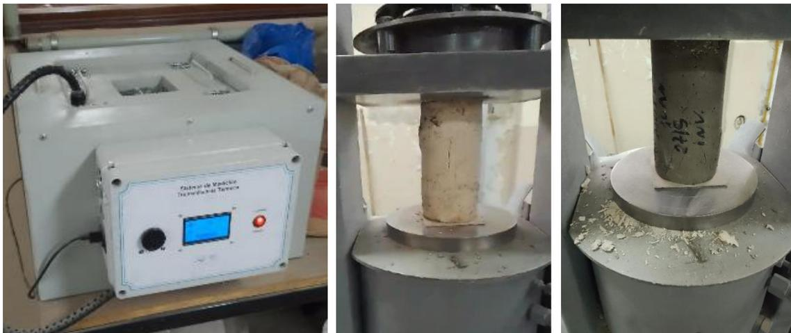
Figura 4: Ensayos de conductividad térmica y resistencia a compresión
