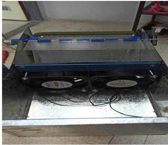
Figura 3 Fotografía de la precámara de control de temperatura de aire
