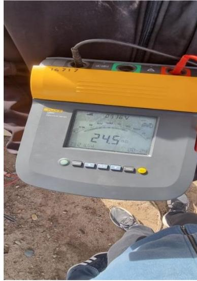
Figura 4. Medición de resistencia de aislación. [Elaboración propia]
