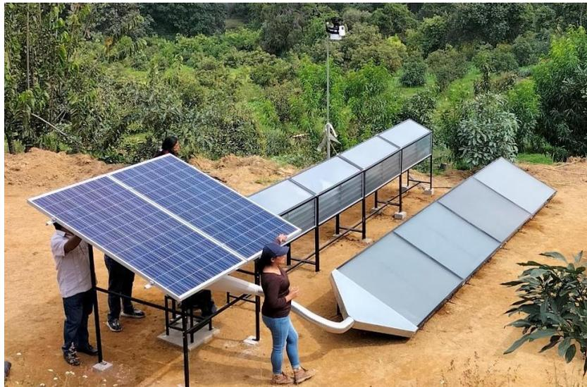
Figura 4 Secador solar tipo túnel [elaboración propia].
