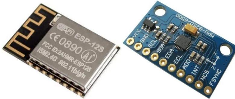
Figura 2. (izq.) Módulo ESP-12S y microcontrolador ESP8266. (der.) Módulo IMU MPU9250.
