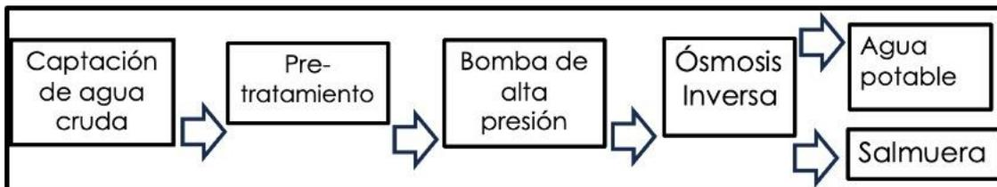
Figura 1. Esquema del proceso de ósmosis inversa (Elaboración propia).
