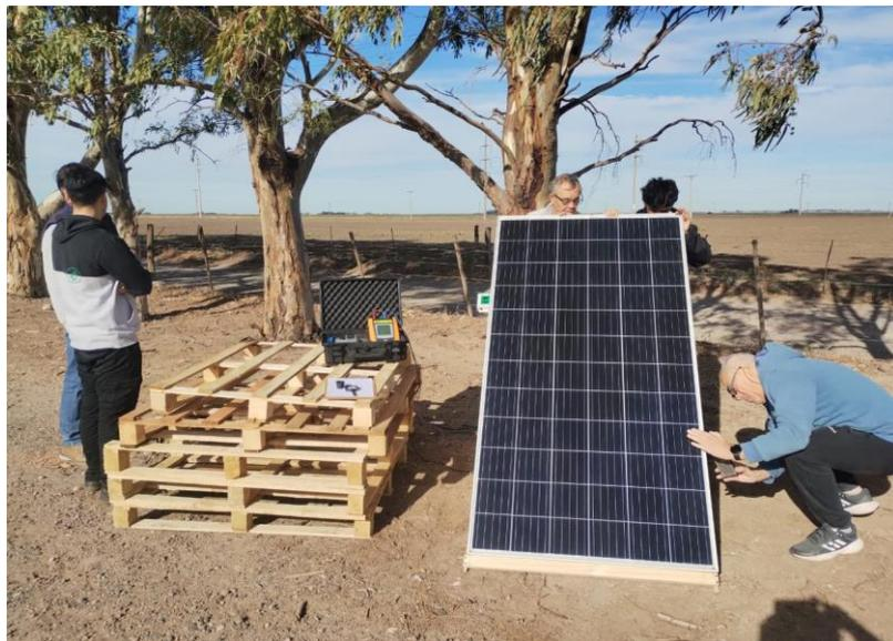
Figura 6. Medición de curva I-V en un panel. [Elaboración propia]
