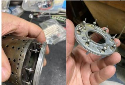
Figura 12 Nuevos inyectores montados en la cámara de combustión con su nueva disposición. [Elaboración propia]
