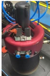
Figura 8 Nueva pieza con conexiones FESTO para la entrada de H<sub>2</sub> a la turbina. [Elaboración propia]
