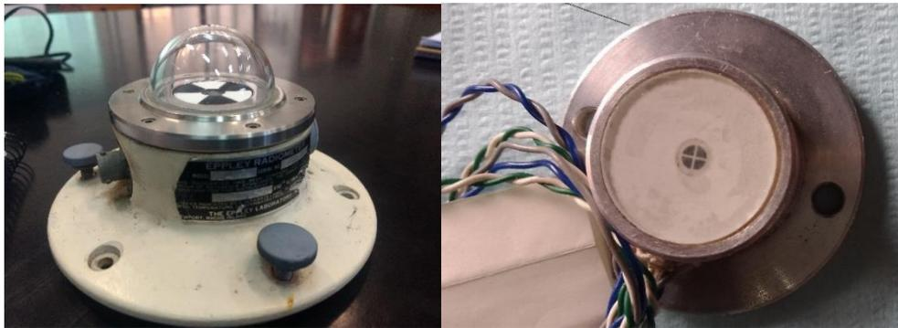
Figura 1 – Izq.: piranómetro Eppley [cortesía GERSolar]. Der: radiómetro fotovoltaico [cortesía CNEA-DES]
