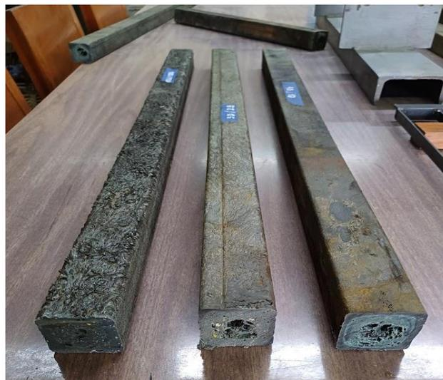
Figura 7: Barras de plástico reciclado ensayadas
