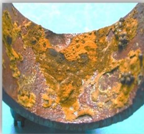
Figura 2a. *Ensuciamiento biológico en la superficie interna de una tubería de acero en agua de mar. [Elaboración propia]*
