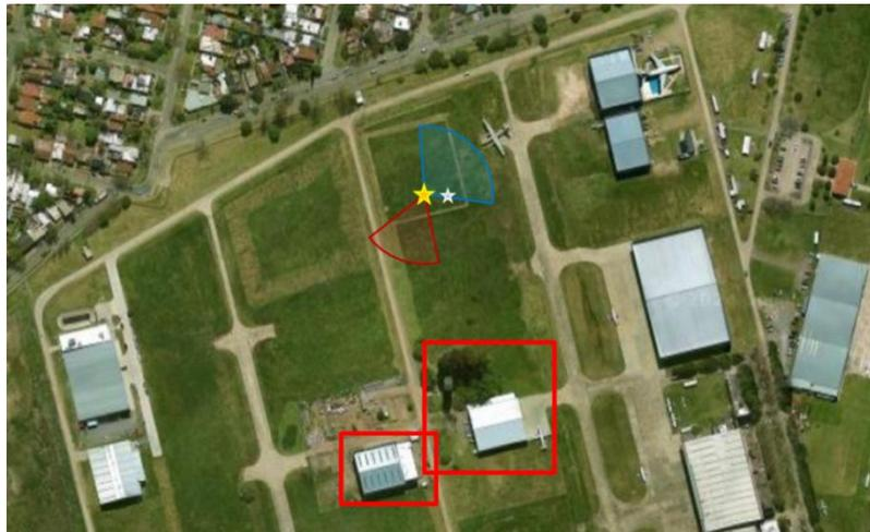
Figura 18. Emplazamiento propuesto de las dos torres. Se demarca la torre del aerogenerador con una estrella amarilla y la torre meteorológica con una blanca. [Imagen de fondo de Google Maps].
