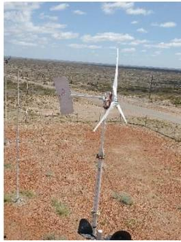
Figura 1. Aerogenerador EOLOCAL modelo AG1000, 1kW, utilizado para realizar el estudio. [elaboración propia]
