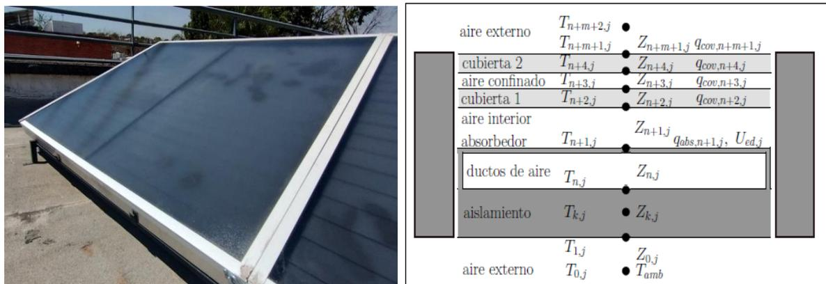
Figura 2 a) Captador solar para calentamiento de aire; b) Esquema de distribución de nodos en la dirección axial [4].
