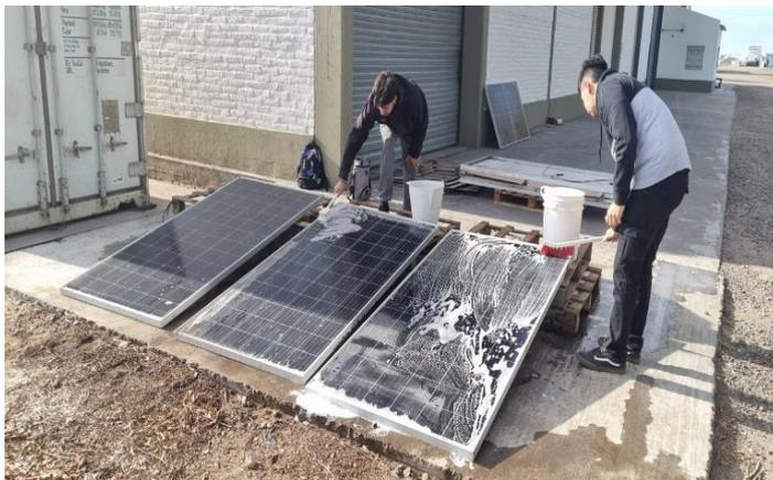
Figura 2. Acondicionamiento previo de los paneles [Elaboración propia]
