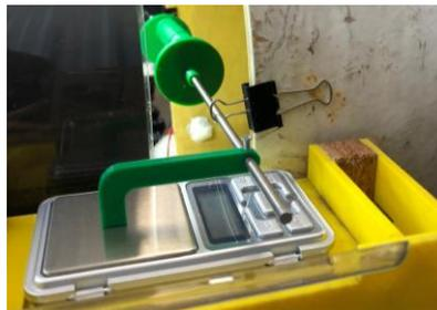
Figura 5 - Esquema funcionamiento ensayo torque estático. [Elaboración propia]
