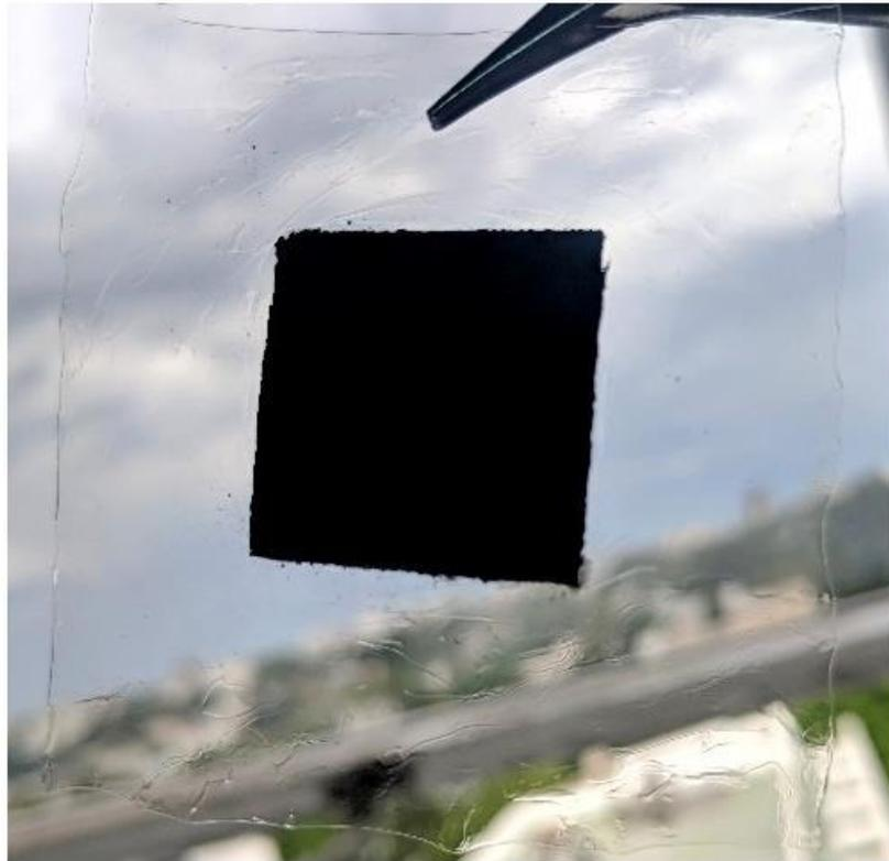
Figura 2 Foto de una MEA desarrollada en el laboratorio y empleada en el prototipo de DMFC. [Foto propia]
