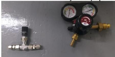
Figura 6 De izquierda a derecha, válvulas reguladoras de caudal y presión. [Elaboración propia]
