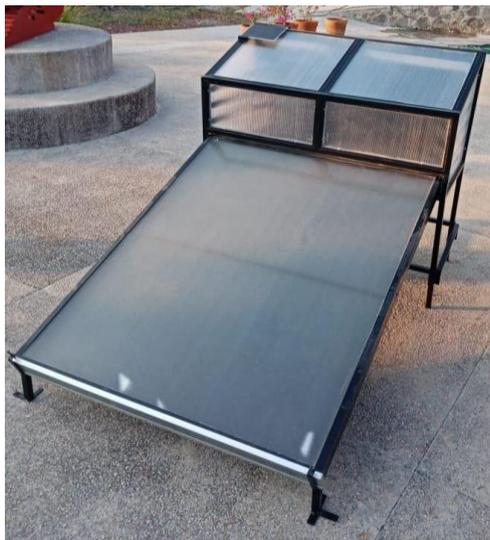
Figura 3 Secador solar tipo gabinete [elaboración propia].
