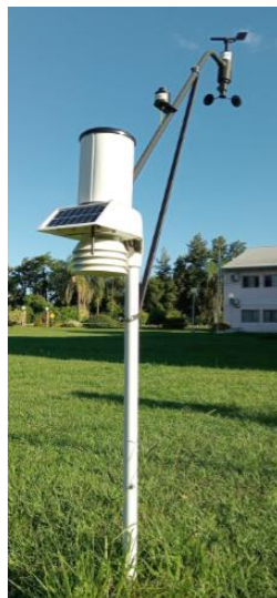
Figura 1: Estación Metereológica PEGASUS, Modelo EP0304 N° 3704.
