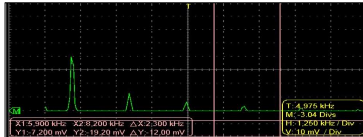
Figura 4: Medición de los armónicos en un osciloscopio realizada por un alumno
